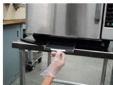
Il filtro e il vassoio raccogli-grasso si trovano sotto la porta del forno. Il filtro è magnetico, rimuovere il filtro e pulire le feritoie di ventilazione circostanti. Lavare il filtro con una spugna o una spugna abrasiva e acqua calda saponata. Estrarre il vassoio raccogli-grasso, drenare il grasso e pulire usando una spugna o una spugna abrasiva e acqua calda saponata. Risciacquare e asciugare bene.
